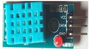
Fig. 2. DHT11 Temperature Sensor
